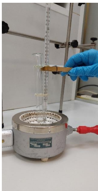
Rys. 2.1. Wykonanie oznaczenia temperatury wrzenia metodą Siwolobowa.
