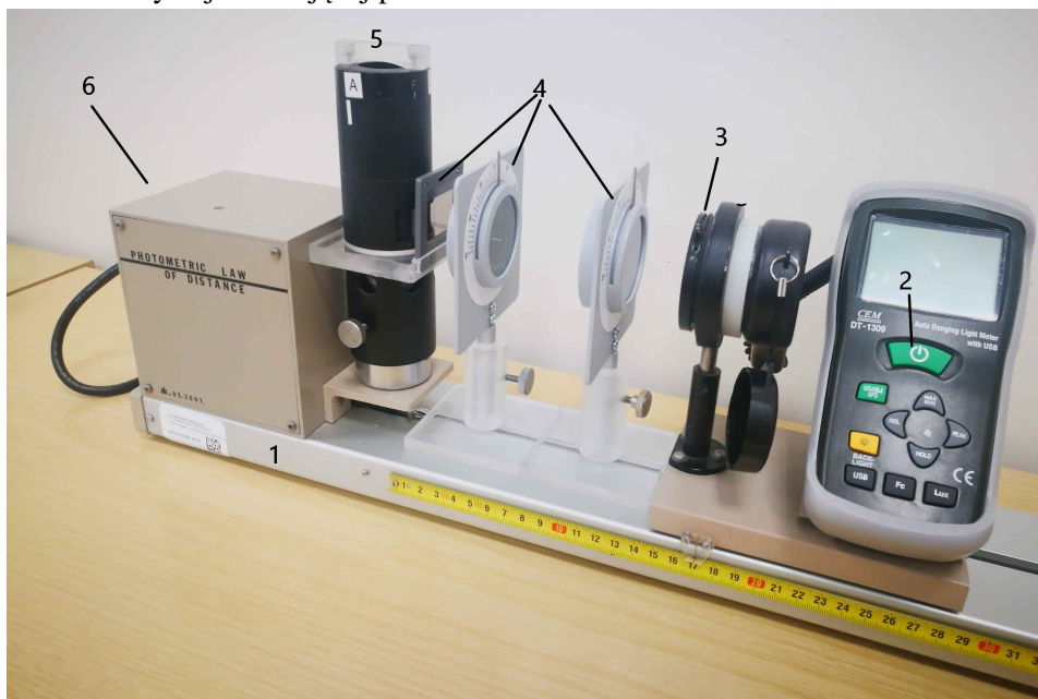
Schemat układu pomiarowego – prawo Malusa
